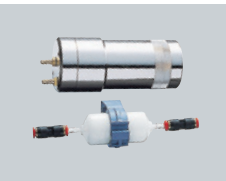
水・エアークリーンフィルター 多孔質中空糸膜を使用した、歯科用精密ろ過膜 フィルター。水回路内の赤サビ、バクテリアの除 去やスケールの付着防止。空気回路内の微粒 子を除去します。
